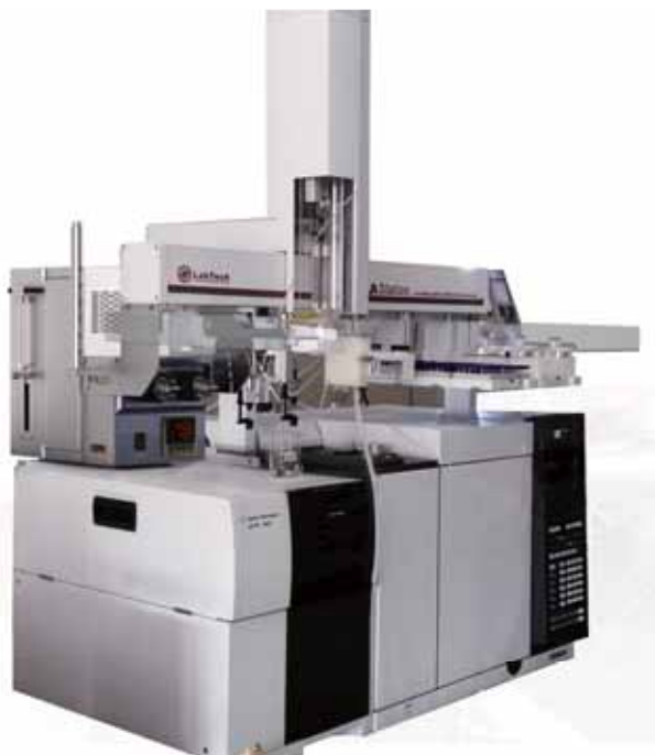
图 1 μGPC 微量凝胶净化 GC-MS 联机分析系统
