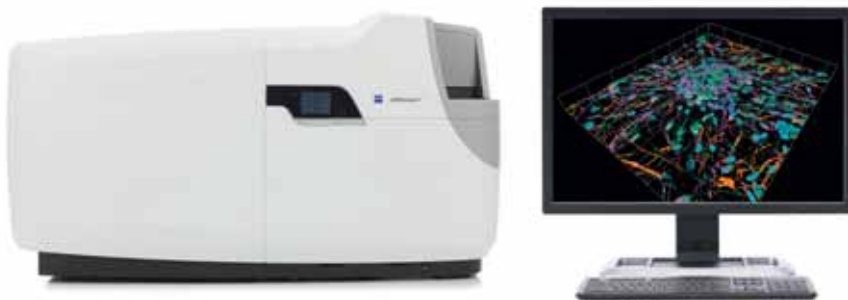
图 4 蔡司细胞发现者 Celldiscoverer7 型全自动校准显微镜光学设计,确保科研人员在较长时间窗口内的科研实验具有较高质量图像和重复再现性能
