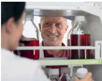
图3 双侧开启，允许两个试验台同时使用一个安全柜
