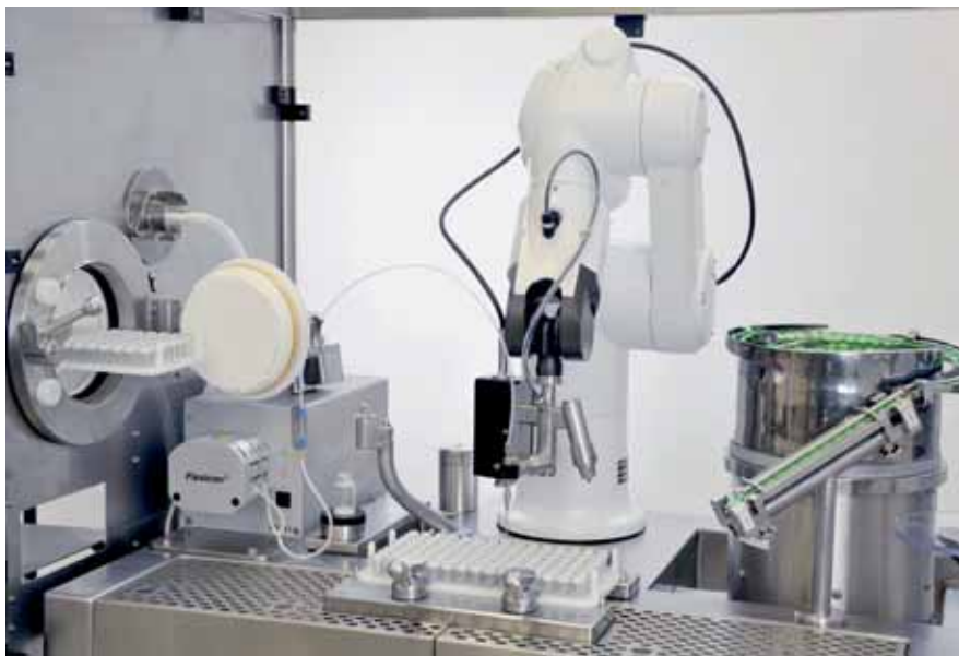
图 3 利用机器人输送安培瓶实例
