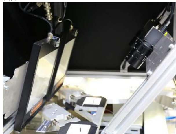
圖4: 第二個檢測箱中傾斜安裝相機和光源系統。插座面板表面的任何不規則缺陷都可以通過投射陰影顯示出來。
