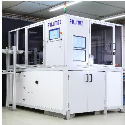
圖2: 檢測系統每次將兩個插座面板從料箱中取出，放在傳送帶上。檢測箱（右圖）中裝有十臺堡盟相機，用於檢測面板質量。根據檢測結果，系統將按照“良品”和“次品”將面板放入下方分選箱中。
