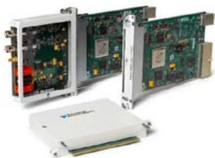
NI FlexRIO的解决方案由两部分模块组成——基于PXI或PXI Express的用户可编程FPGA模块（数字后端）及与其对应的前端I/O适配器模块，用户可对NI FlexRIO FPGA模块上的FPGA进行重配置开发，结合不同的I/O适配器模块，可实现自定义实时板载信号处理、高速闭环响应等应用，从而将软件自定义的范围从处理器进一步扩展到I/O模块的数字后端。
