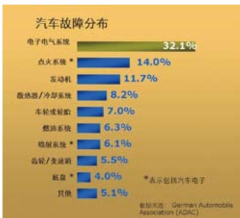
图1.1 汽车故障分布图
