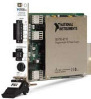
NI可编程电源与SMU可作为高精度直流输出, 同时可进行精准的电压和电流测量。这些仪器可在自动测试系统或实验室中提供恒定电流或电压、快速扫描IV特性曲线、或者进行漏电流测量等。
