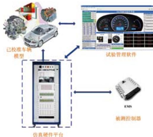
图2.1 EMS HIL测试系统结构图
