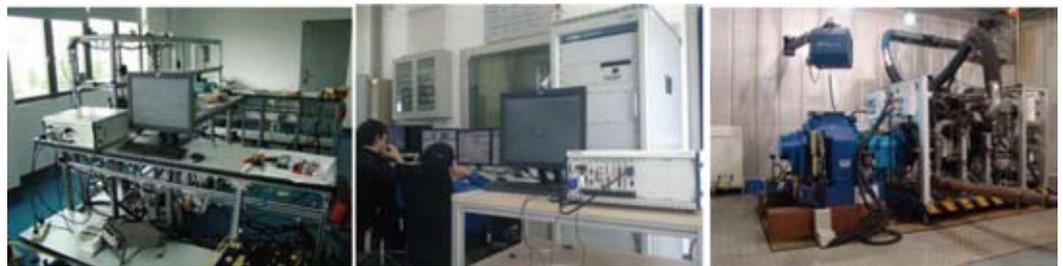
(a) 整车电环境的半实物仿真 (b) 发动机台架试验
