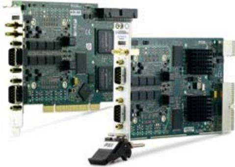
接受优化的NI-XNET CAN、LIN和FlexRay接口，适合需要数百个CAN、LIN与FlexRay frames帧和信号（如：硬件在环仿真、快速控制原型、总线监控、自动化控制.....）。
