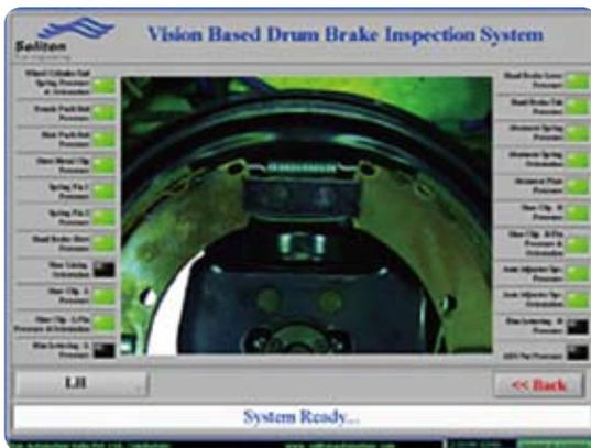
十周之内利用最新虚拟仪器和机器视觉技术，开发一个刹车全自动检测系统。
