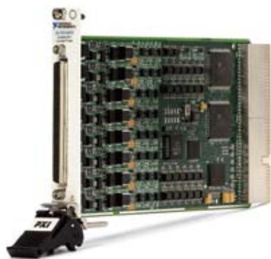
NI计数器/定时器设备具有多达8个32位计数器, 提供一系列与时间相关的测量, 并且作为复杂测量系统的组成部分可以实现所需的严格定时功能。计数器/定时器可用于:
