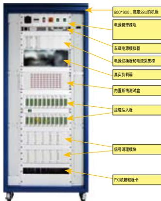
图2.2 HIL测试系统硬件平台示意图
