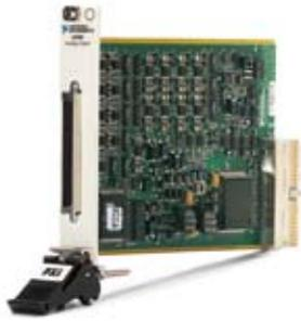
NI PXI模拟电压和电流输出设备涵盖了从基本的软件定时输出到复杂的高速波形发生的多种应用。
