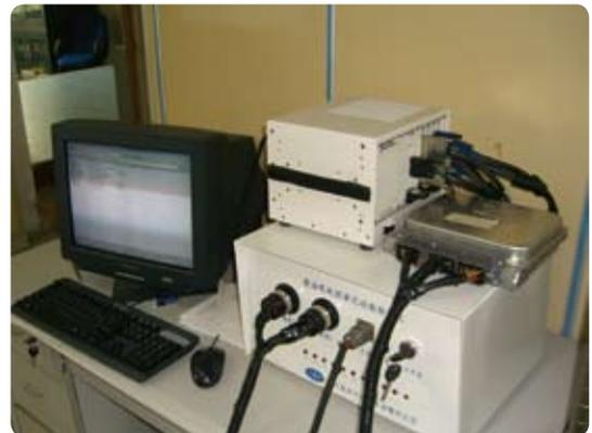
图8 电控单元功能检测仪
