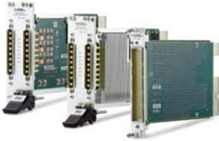
故障注入单元 (FIU) 的设计, 适合硬件在环 (HIL) 应用和电子可靠性测试。每个模块具有一系列馈通通道, 在关闭状态下使得开关对于系统是透明的。用户可打开或中断连通两条故障总线其中一条的通道, 每条故障总线的多路复用器均配备4种可能的输入。用户可使用这种架构仿真断开或被中断的连接以及管脚之间的短路、针对电池电压的短路和针对各路通道上的对地短路。被NI LabVIEW实时模块控制时, 该FIU非常适合验证控制系统的可靠性, 如: 引擎控制单元 (ECU)、全权数字引擎控制器 (FADEC), 以及更多其它需要带动高负载的应用。
