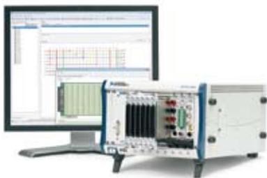
NI SwitchBlock作为灵活的大型开关方案由带有继电器插槽的Carrier和继电器卡组成, 能最大程度减少连线, 简化连接。每个NI SwitchBlock Carrier占用4个PXI槽位并可容纳6块NI SwitchBlock继电器插卡, 通过Carrier背板的模拟总线连接连接这些插卡之后, 可以构建超过2000个交叉点的大型矩阵。通过扩展桥可以进一步连接多个Carrier, 构建更大型的开关矩阵。
