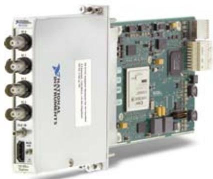
NI带有可编程FPGA的数字化仪由模拟前端和数字后端两部分模块组成。模拟前端是一个带有ADC的前端A/D模块，数字后端是板载高性能Xilinx FPGA与DRAM的FlexRIO FPGA模块。这样，您可以根据应用需要选择合适的前端ADC，同时可通过LabVIEW FPGA模块对数字后端的FPGA进行编程，满足实时在线信号处理或自定义触发等需求。
