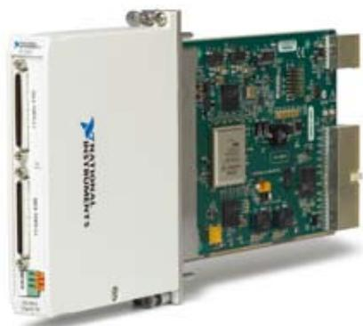
NI带有可编程FPGA的高速数字I/O由前端电路和数字后端两部分模块组成。数字后端是板载高性能Xilinx FPGA与DRAM的FlexRIO FPGA模块。这样，您可以根据应用需要选择合适的数字I/O前端模块，同时可通过LabVIEW FPGA模块对数字后端的FPGA进行编程，为协议感知等应用提供更灵活的解决方案。
