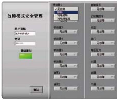
图5 LabVIEW中故障发生控制面板
