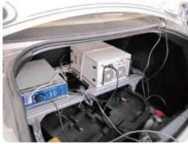
图4 ESP数据采集系统PXI机箱
