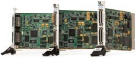
NI运动控制用于测试、测量和控制等平台。NI提供PCI和PXI插入式运动控制器，以及NI C系列驱动和用于NI CompactRIO的驱动接口模块。工程师使用NI LabVIEW、功能齐全的控制器的、完整的仪器驱动和电机创建高级运动控制程序，开发速度更快，成本更低。
